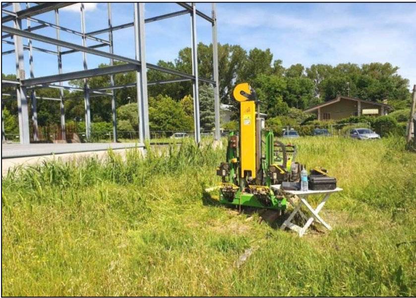
Esecuzione della Prova Penetrometrica Statica con piezocono e cono sismico (SCPTU01)
